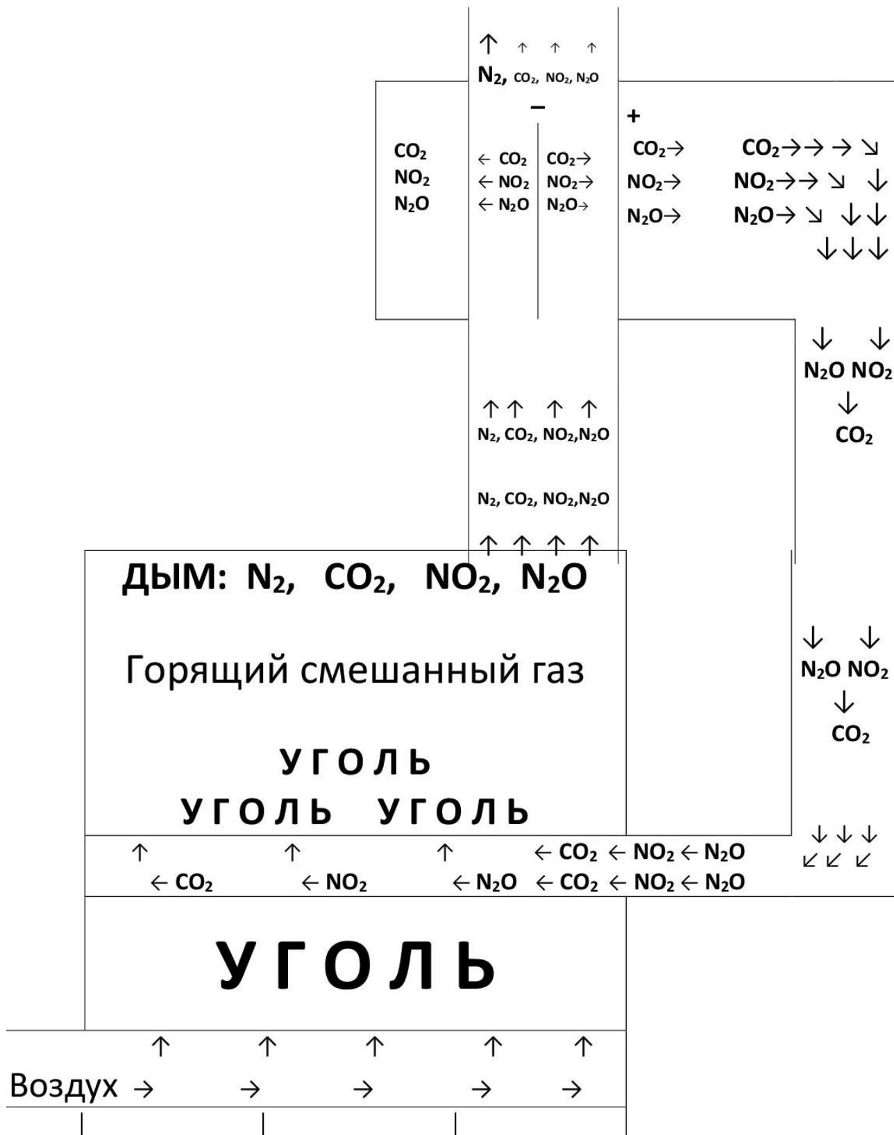
*Схема организации оборотного дыма для сокращения выбросов парниковых газов и повышения кпд угольной топки.*
